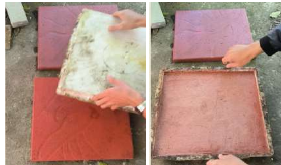
Hình 7. Công tác tháo khuôn và bảo dưỡng
