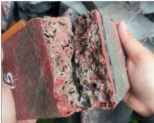
Hình 12. Cấu tạo mẫu gạch khi thay đá dăm bằng thủy tinh.
